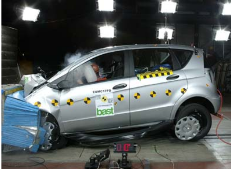
Déploiement des airbags frontaux sur la Mercedes classe A lors d'un test EuroNCap
