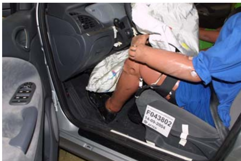
Airbag genoux dans Citroën C5 après déploiement lors d'un test EuroNCap
