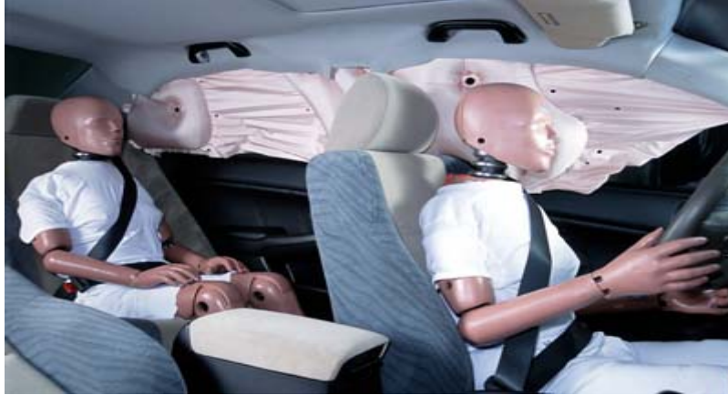
L'airbag rideau de la Honda Accord se déploie en seulement 15 millisecondes
