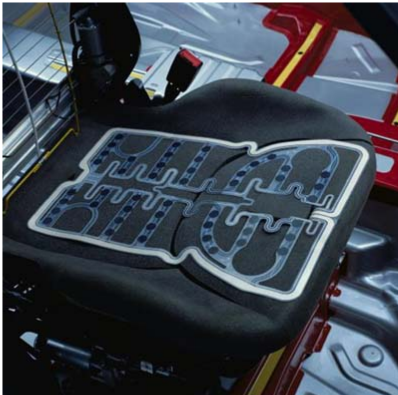
Tapis de mesure du poids et de sa répartition - Mercedes
