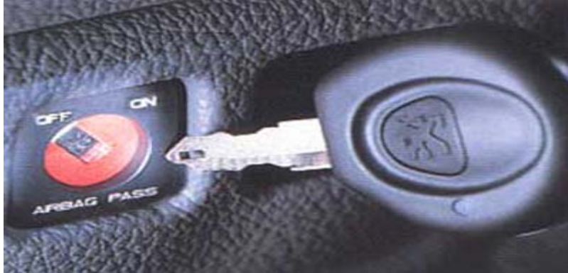
Neutralisation de des airbags - Peugeot
