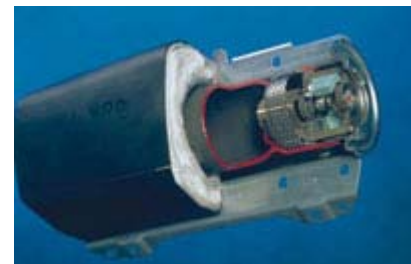
Airbag pour passager avant dans le tableau de bord - Autoliv
